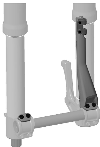
Abb. 2: Mast und Abdeckplatte montiert
