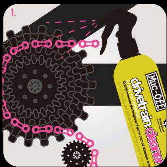
噴灑「傳動系統清潔劑」在鏈條與飛輪齒上。
