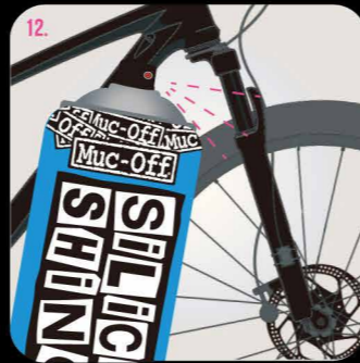
在登山車的前後避震器上使用「防污亮光噴劑」, 可使懸吊系統運作更加順暢, 並降低耗損。
