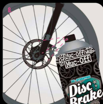
在碟盤、煞車皮或來令片上噴灑「高效碟盤清潔劑」, 再將殘餘髒汙擦拭去除。
